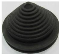
2 – Ввод кабельный PG29, наружный диаметр 36мм, для ввода кабеля подключения путевого электроинструмента. Диаметр вводимого кабеля от 18мм до 24мм. Количество на ШУЭС-М – 1шт.
