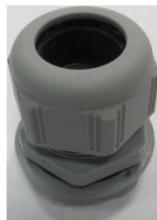
4 – Ввод кабельный PG29, наружный диаметр 36мм, для ввода кабелей отходящих фидеров. Диаметр вводимого кабеля от 18мм до 24мм. Количество на ШУЭС-М (от 1 до 12) – зависит от исполнения (количества отходящих фидеров).
