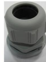
3 – Ввод кабельный PG16, наружный диаметр 22мм, для ввода кабелей от термодатчиков ТДР-074, ввода кабеля контроля и управления от аппаратуры СЦБ и ввода кабеля связи от ССШ-ЭО. Диаметр вводимого кабеля от 6мм до 13мм. Количество на ШУЭС-М – 16шт.
