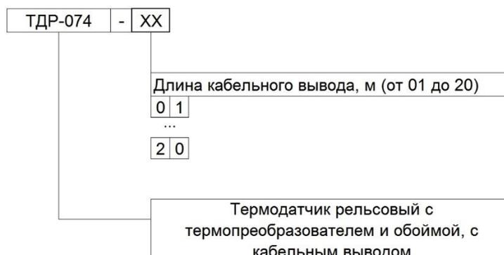
Пример записи обозначения термодатчика с длиной кабельного вывода 8 м при заказе и указании в документации: «Термодатчик рельсовый с термопреобразователем и обоймой, с кабельным выводом 8 м. ТДР-074-08, ТУ 3185-189-53304326-2013».
